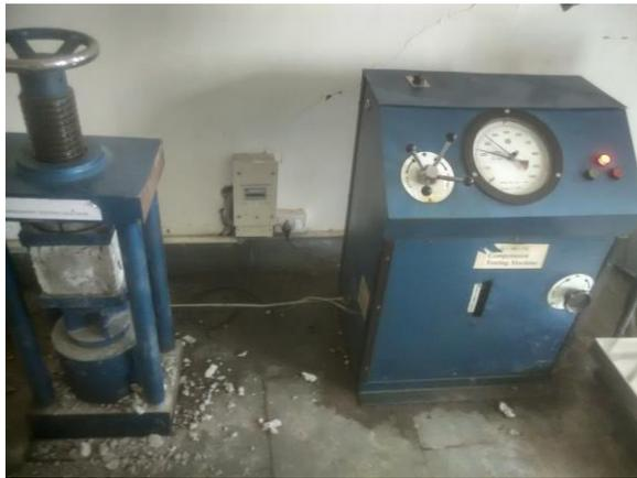
Fig: 3 COMPRESSION STRENGTH TESTING MACHINE
