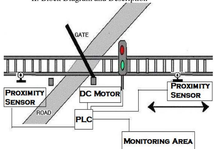
Fig.1. Block Diagram Of Project<sup>[1]</sup>
