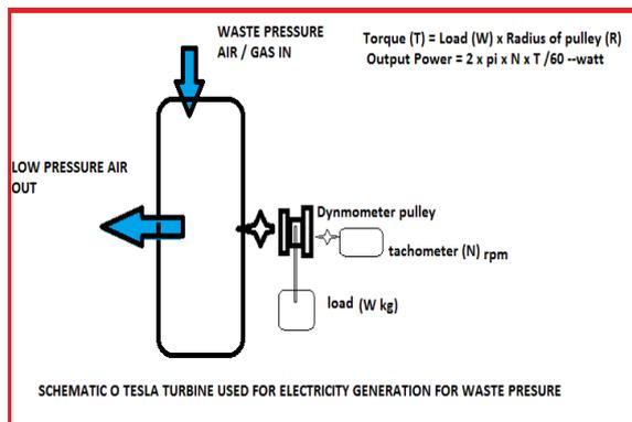
Here input parameter will be Pressure of inlet air and output parameter will be
