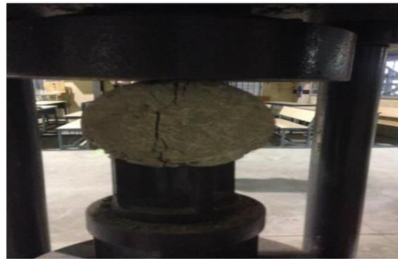
**Figure-3 Split tensile test**
