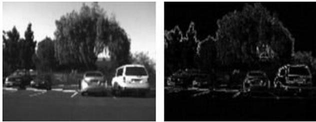
Fig 2.Sobel Edge Detection
