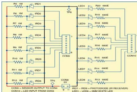
**Fig. 1: Sensor Module**
