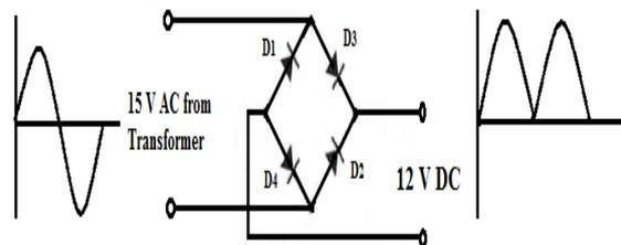
Figure 3. Rectifier Circuit
