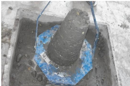
**Fig: 3 Slump test**
